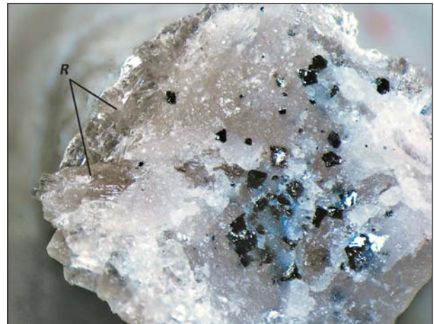
Рис.1. Кристаллы роймиллерита (R) с церусситом (белые) и яacobситом (черные). Ширина поля 2.9 мм.
